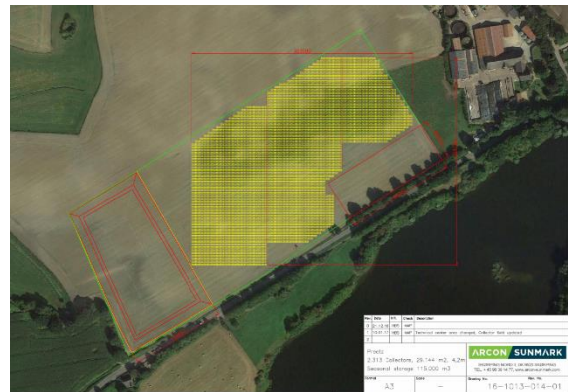
Voraussichtliche Planungsvariante des B-Planverfahrens – orientiert an der End-Ausbaustufe (Solarfeld: 29.000 m 2 ; Pufferspeicher: 1.200 m 3 ; Saisonal-Speicher: 115.000 m 3 )
